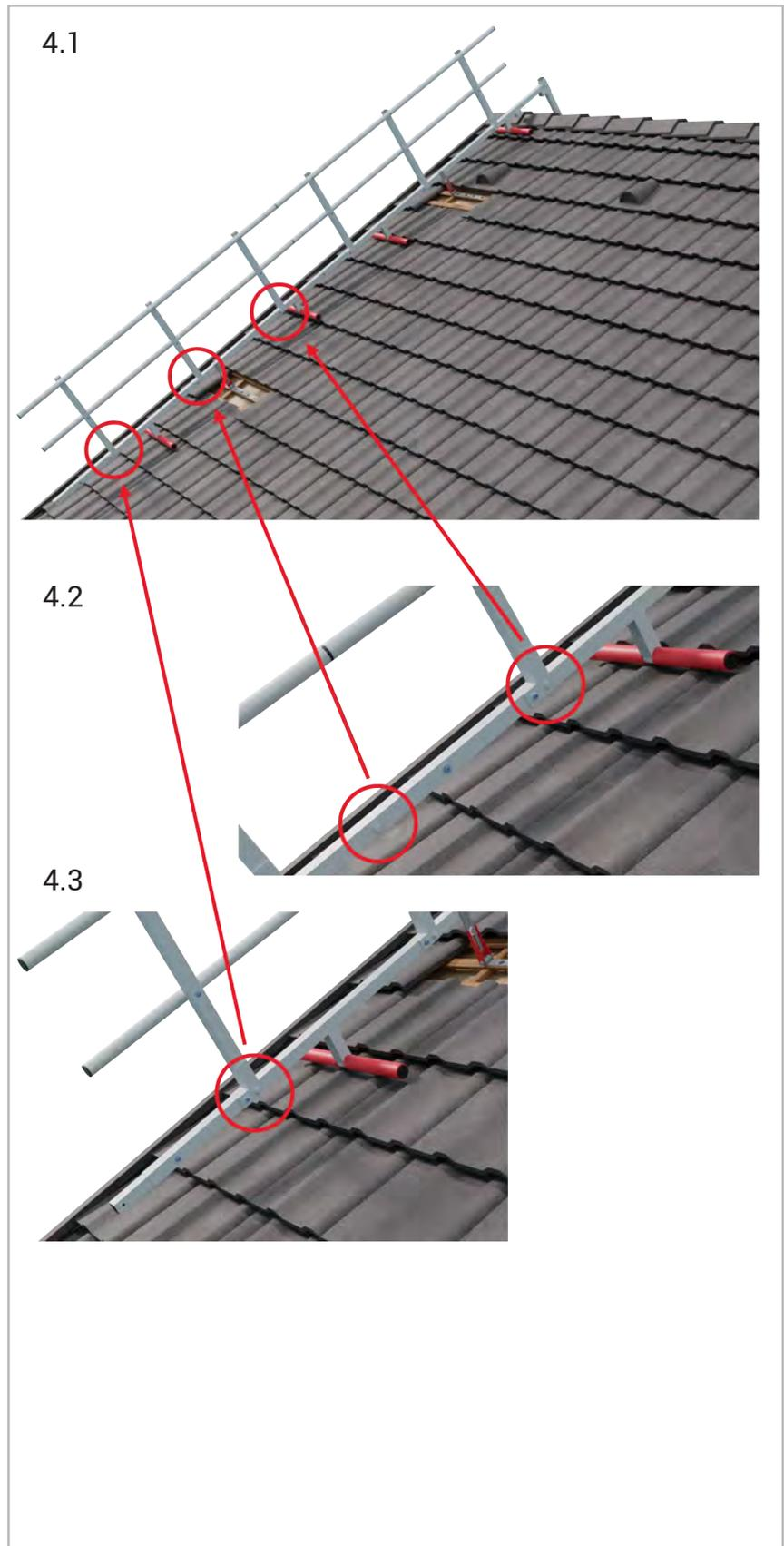
E Die Demontage erfolgt in umgekehrter Reihenfolge wie die Montage
