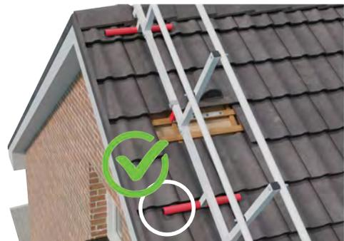
**Falsche Montage: Die Dachbalken liegen NICHT vollständig auf dem Dach.**
