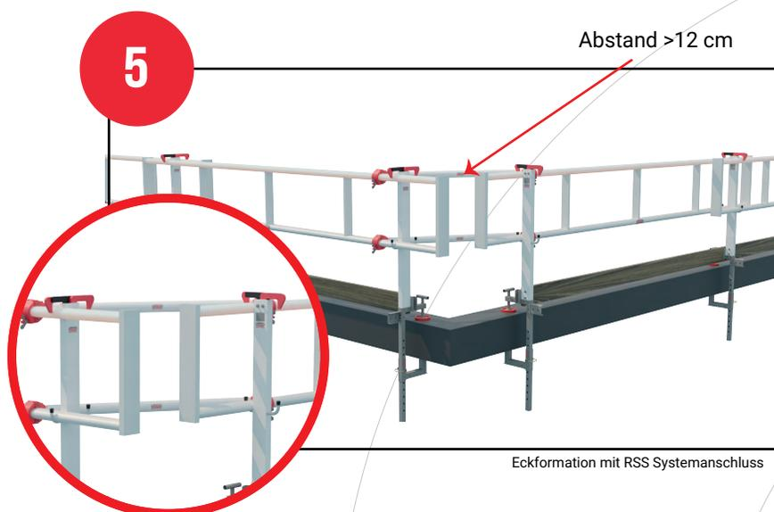
Wenn der Abstand zwischen den Geländern mehr als 12 cm beträgt, muss der RSS Systemverbinder (Art.nr: S268) verwendet werden. Dieser sorgt dafür, dass eine sichere Verbindung entsteht (siehe Abbildung 5).
