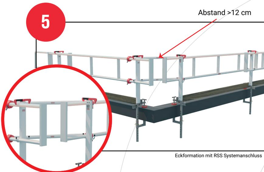
Wenn der Abstand zwischen den Geländern mehr als 12 cm beträgt, muss der RSS Systemverbinder (Art.nr: S268) verwendet werden. Dieser sorgt dafür, dass eine sichere Verbindung entsteht (siehe Abbildung 5).
